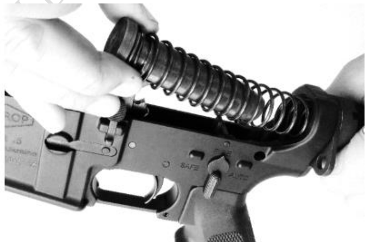
Рисунок 14. Від'єднання буфера і зворотної пружини.
