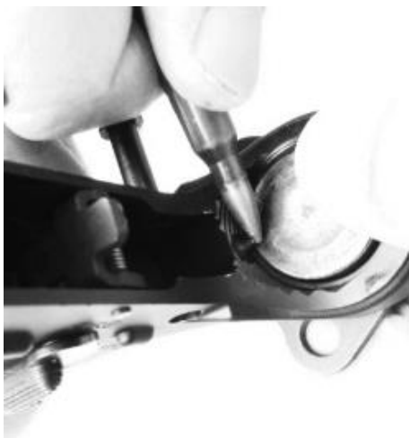
Рисунок 14. Від'єднання буфера і зворотної пружини.
