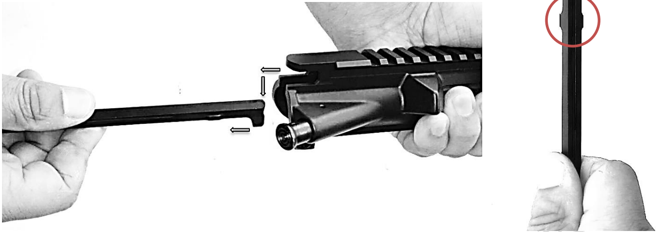
Рисунок 10. Від'єднання затворної рами із затвором у зборі та рухів'я перезарядження.
