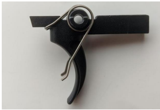
Рисунок 33.4. Встановлена пружина спускового гачка.
