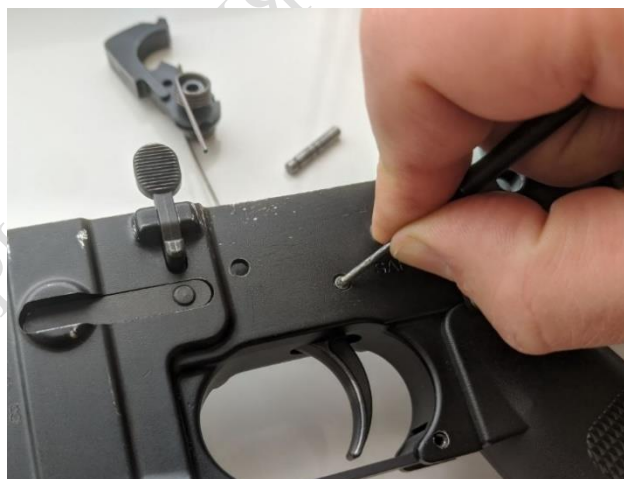
Вийняти спусковий гачок з пружиною. Зняти пружину з цапф гачка спускового (аналогічно як бойову пружину з курка).
