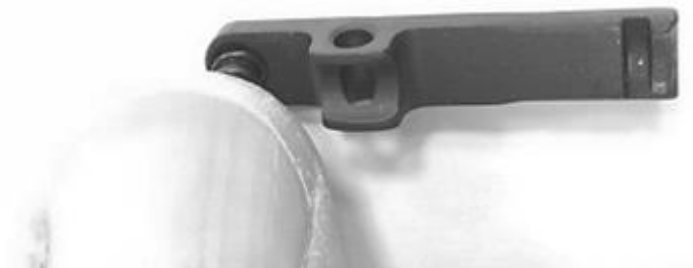
Рисунок 32. Утримання пружини викидача при її знятті або встановленні.
