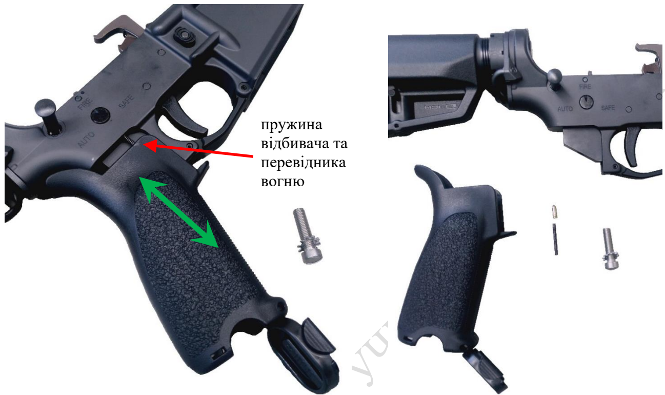
Рисунок 33.1. Зняття пістолетного руків'я.
