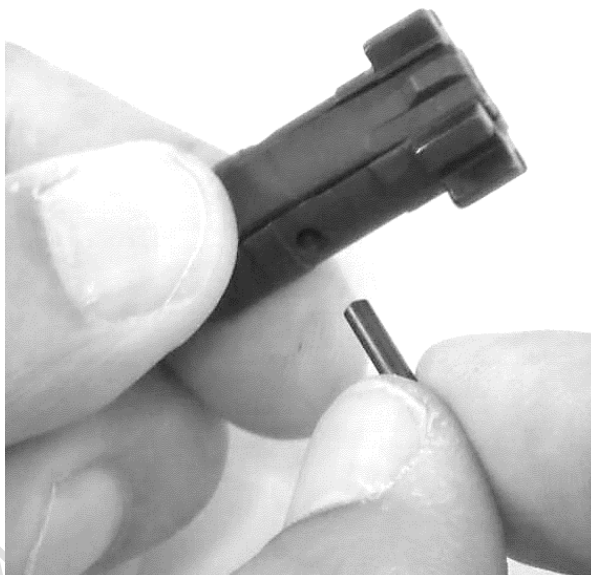
Рисунок 33. Утримання викидача при встановленні осі викидача.
